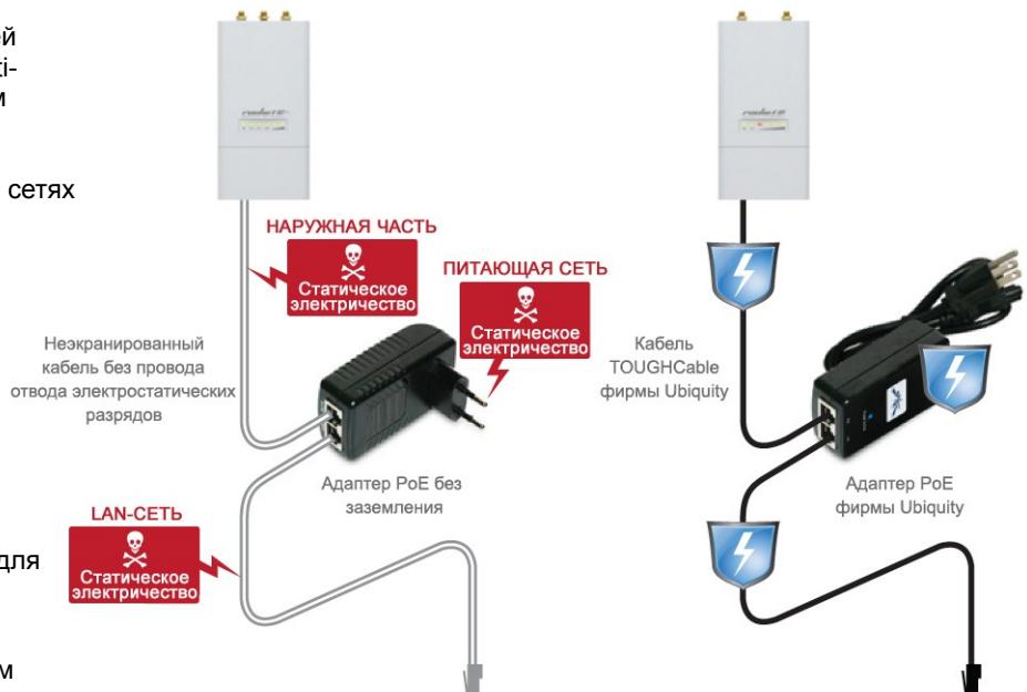
**УСЛОВИЯ ИСПОЛЬЗОВАНИЯ:** Установка радиооборудования Ubiquiti должна производиться специалистами. В качестве условий гарантии на продукцию обязательно использование экранированного Ethernet-кабеля и заземления. Специалисты, осуществляющие монтаж, несут ответственность за выполнение местных нормативов, в том числе за эксплуатацию в пределах разрешенных частотных каналов, допустимой выходной мощности и в рамках требований по динамическому выбору частоты (DFS).
