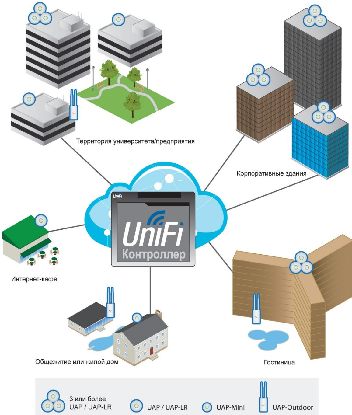
**Беспроводное расширение.** Воспользуйтесь функцией создания нисходящих беспроводных каналов связи. Один проводной восходящий канал связи от точки доступа системы UniFi поддерживает 4 беспроводных нисходящих канала связи, обеспечивающих возможность беспроводного присоединения устройств в их изначальном состоянии и изменения сетевой топологии в реальном времени.
