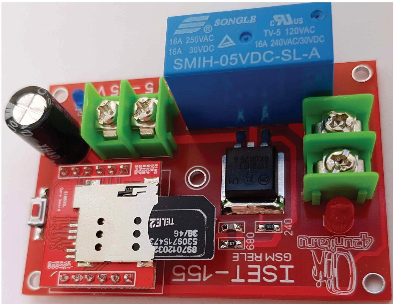
Установка SIM карты в слот GSM модуля
