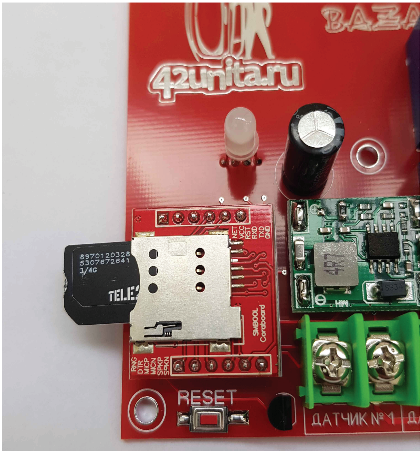
Установка SIM карты в слот GSM модуля.
