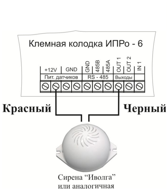
Подключение сирены с током потребления до 1А
